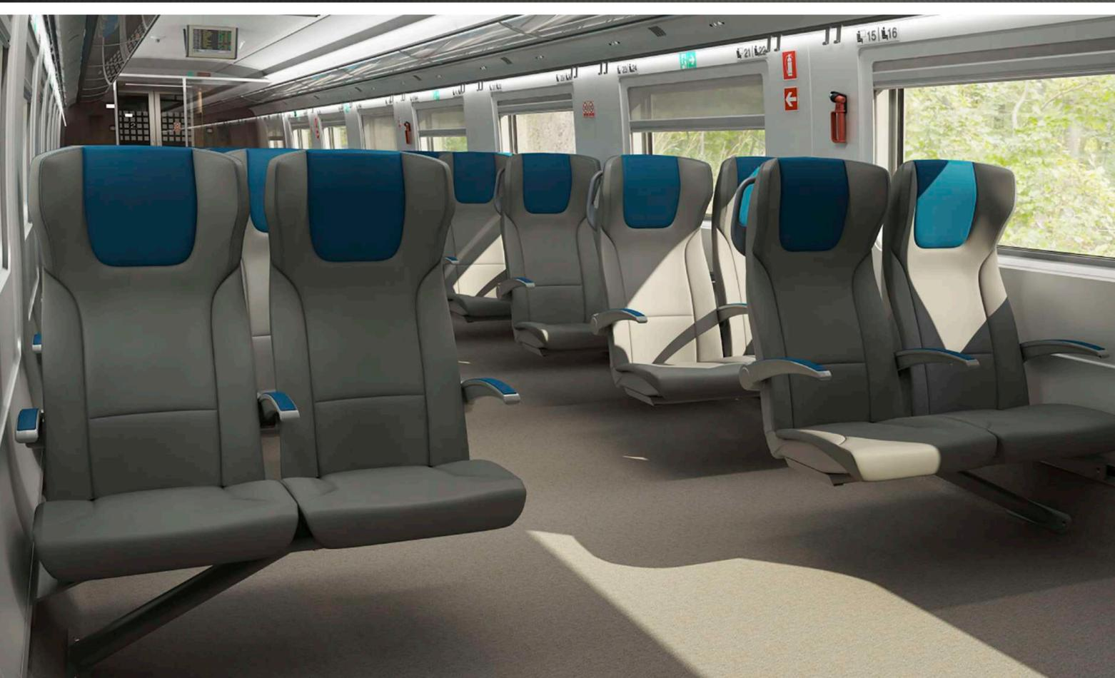
È disponibile in tutte le configurazioni di fissaggio e con tutte le funzionalità e accessoristica richieste dal mercato, ed offre un **concetto di smontabilità rapido e semplice** che permette di smontare le imbottiture e sostituire i rivestimenti in solamente **4 minuti svitando una sola vite**.
